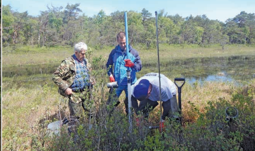
Montaż piezometrów w rezerwacie przyrody Białogóra (fot. J. Przytarska)
